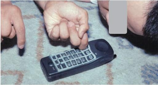
図1 エポキシ系パテで作製したダイヤルボタンガードを取り付けて電話をかける、アテトーゼ型脳性麻痺者
